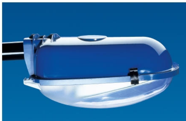
Oprawa OPALO 1 skonstruowana została dla wysokoprężnych źródeł światła: tubularnych sodowych o mocy do 100 W oraz eliptycznych rtęciowych do 125W. OPALO 2 do 150W.
